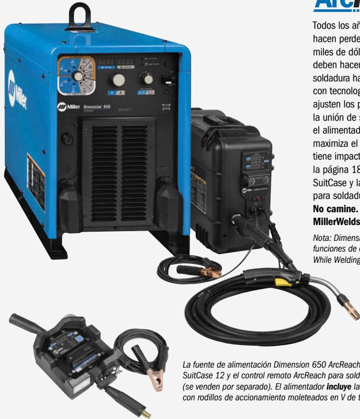
La fuente de alimentación Dimension 650 ArcReach se muestra con el alimentador ArcReach SuitCase 12 y el control remoto ArcReach para soldadura convencional con electrodos/TIG (se venden por separado). El alimentador **incluye** la antorcha BTB Bernard 300 A **O BIEN** S-Gun™ con rodillos de accionamiento moleteados en V de tamaño doble reversibles (0,045 y 1/16 in).
