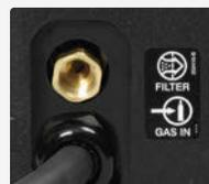
La **entrada de gas retrocedida a la parte posterior del estuche** está protegida contra el contacto incidental con el cable de soldadura. Esto garantiza un suministro de gas de protección uniforme y libre de contaminantes a la antorcha. La **válvula de gas con filtro doble** evita la acumulación de suciedad que afectaría el flujo de gas.
