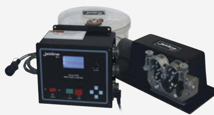
El alimentador de alambre frío Jetline se usa en aplicaciones de soldadura por arco de tungsteno protegida por gas (GTAW) y soldadura por arco de plasma (PAW) automatizadas para agregar "relleno" a una junta de soldadura.
