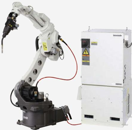
El proceso de alambre activo es un proceso de soldadura por arco corto avanzado que combina la trayectoria del movimiento del robot, la forma de onda de la máquina de soldar y el servocontrol de la alimentación de alambre mientras que, simultáneamente, invierte el avance del alambre en el cortocircuito para controlar con precisión la deposición de soldadura.
