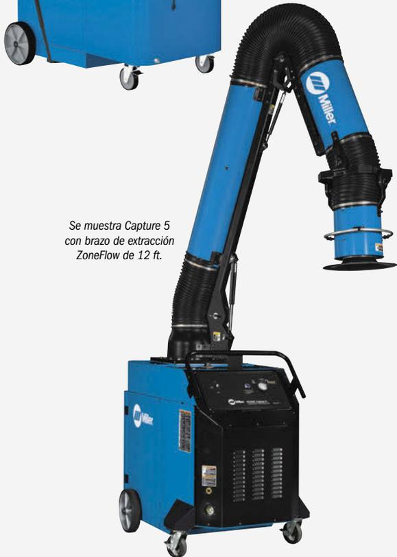
Se muestra Capture 5 con brazo de extracción ZoneFlow de 12 ft.
