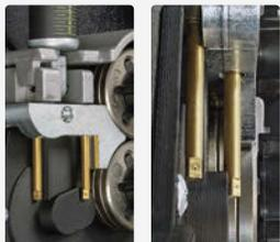
Los pasadores de la guía de entrada de fricción **ultrabaja** facilitan la carga del alambre sin deformarlo en el camino hacia los rodillos de accionamiento. Esto mejora el desempeño de la alimentación.
