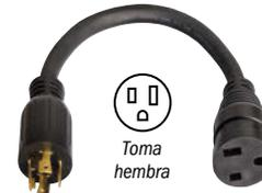
**Cordón adaptador de bloqueo con giro 301489** Para Fusion. L14-30R a NEMA 6-50R. Adapta el enchufe de bloqueo con giro de 120/240 V del motor al enchufe común de Millermatic y Spectrum de 240 V.
