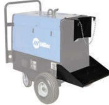
**Conjunto de montaje de cilindro de gas 300918** Para Bobcat y Trailblazer a gas/LP (excepto los modelos Air Pak). Diseñado para su uso con el tren rodante, el armazón de protección o solo. Incluye bandeja de base con soporte para botella, bastidor de soporte vertical y cadena de seguridad.
