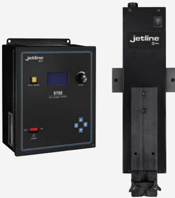
El control de la longitud del arco Jetline mantiene una longitud del arco constante mediante el control del voltaje del arco en aplicaciones de soldadura por arco de tungsteno protegida por gas (GTAW) o de soldadura por arco de plasma (PAW).
