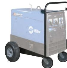
**Tren rodante todo propósito con neumáticos Never Flat™ 300477** Para Trailblazer 325 Diesel. Incluye dos neumáticos de 15 in para servicio pesado, dos ruedas giratorias de goma de 8 in y una manija para servicio pesado. Se recomienda para todas las superficies y aplicaciones, y es fácil de trasladar en el lugar de trabajo.
