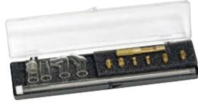
(0,040, 1/16 in) de los elementos siguientes: sujetador de 180°, sujetador de 45°, sujetador de 90° y electrodo de tungsteno ceriado al 2 % de 7 in.
