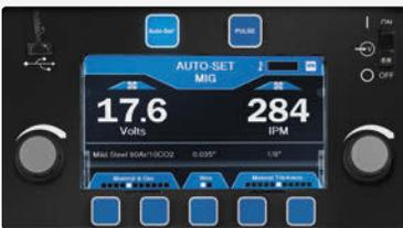
**La interfaz fácil de comprender con pantalla LCD a color de 7 in** garantiza una configuración apropiada para la máquina y la selección de los parámetros correctos, lo que reduce el tiempo de configuración y aumenta el tiempo de soldadura.
