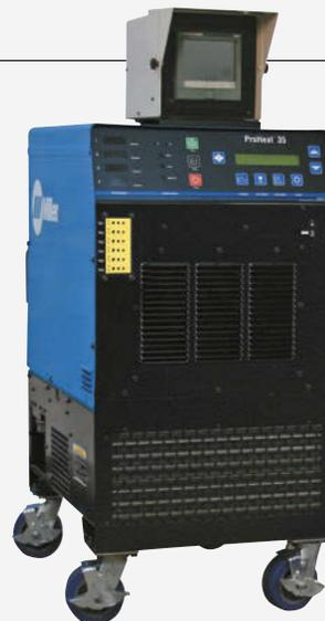
Se muestra la fuente de alimentación ProHeat 35 con enfriador de servicio pesado para calentadores por inducción, el tren rodante y el registrador digital.
